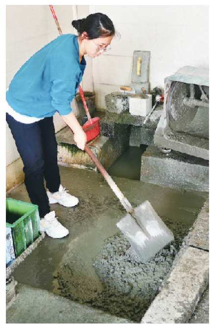
杨俊燕正在对混凝土配合比进行试验
