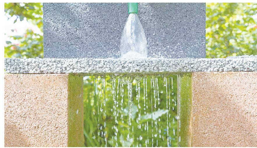
透水混凝土透水性能测试
