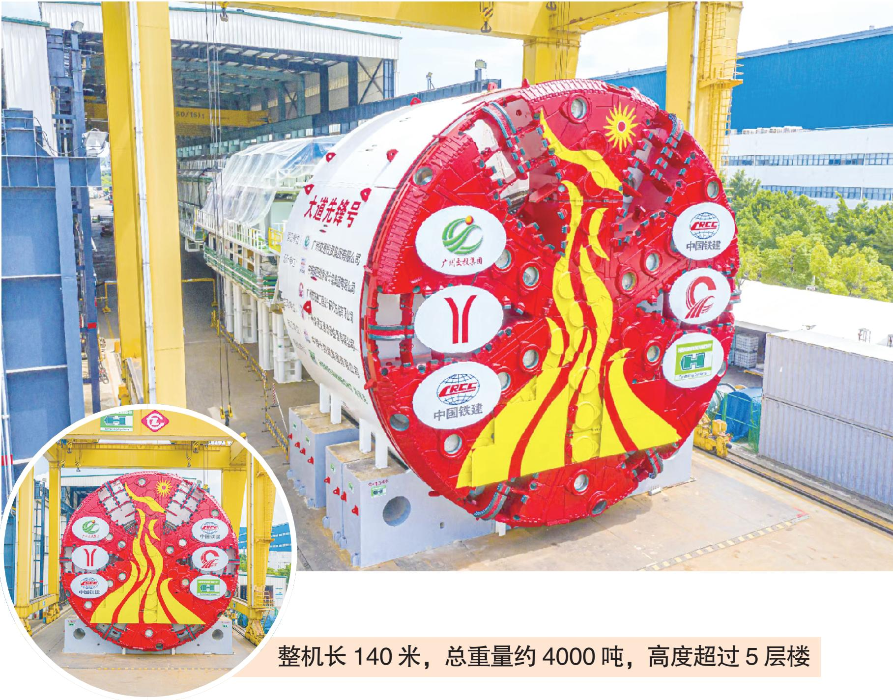
整机长 140 米，总重量约 4000 吨，高度超过 5 层楼
