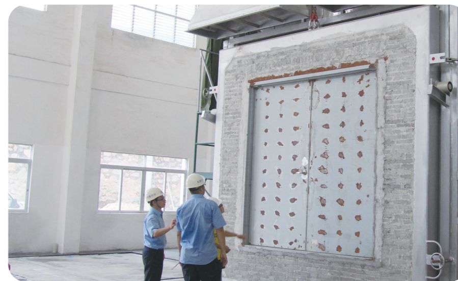
广州建材工业研究所防火门耐火测试
