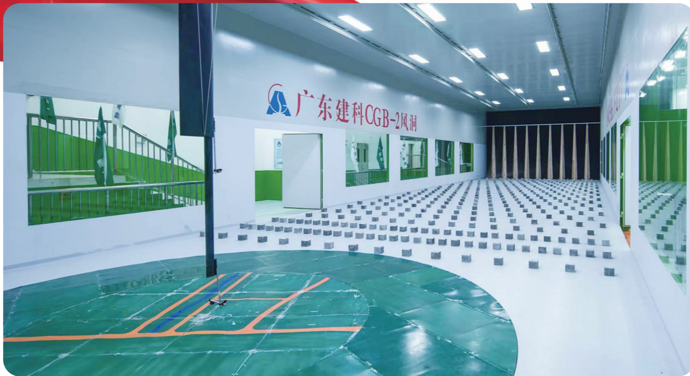
省总站拥有全国最大的民用建筑风洞实验室
