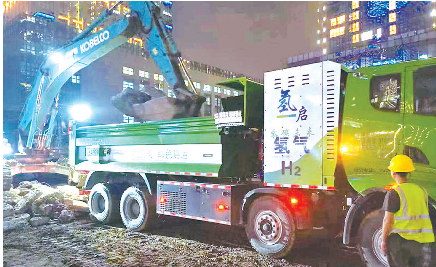
氢燃料电池自卸车在白云艺术广场建设项目进行渣土清运（通讯员供图）
