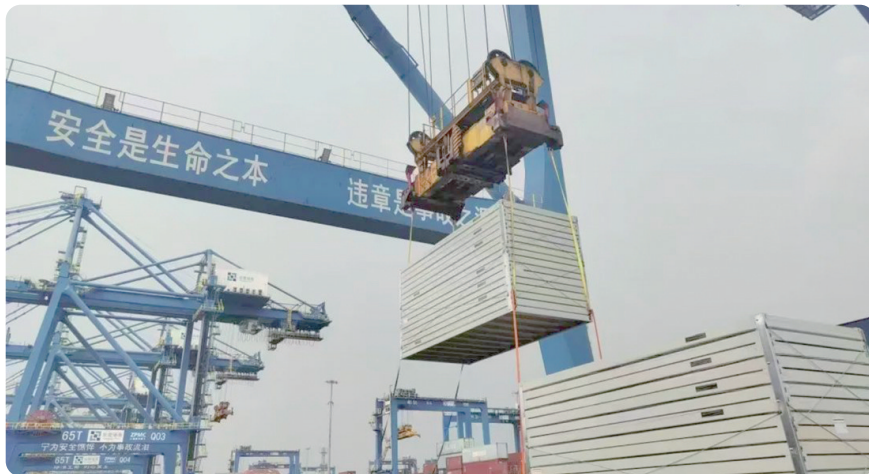
此次出运的模块化房屋以杆件及板材形式装船运输（图源：东莞发布）
