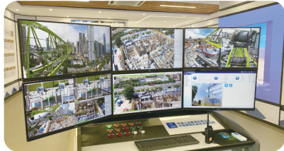
项目采用了5G智能塔机远程控制技术
