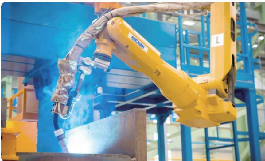
焊接机器人实现焊接生产智能化（图源：深圳市住房和建设局）
