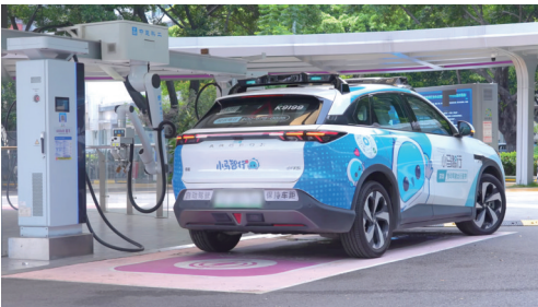
中建科工移动充电机器人正在为无人驾驶电车充电
