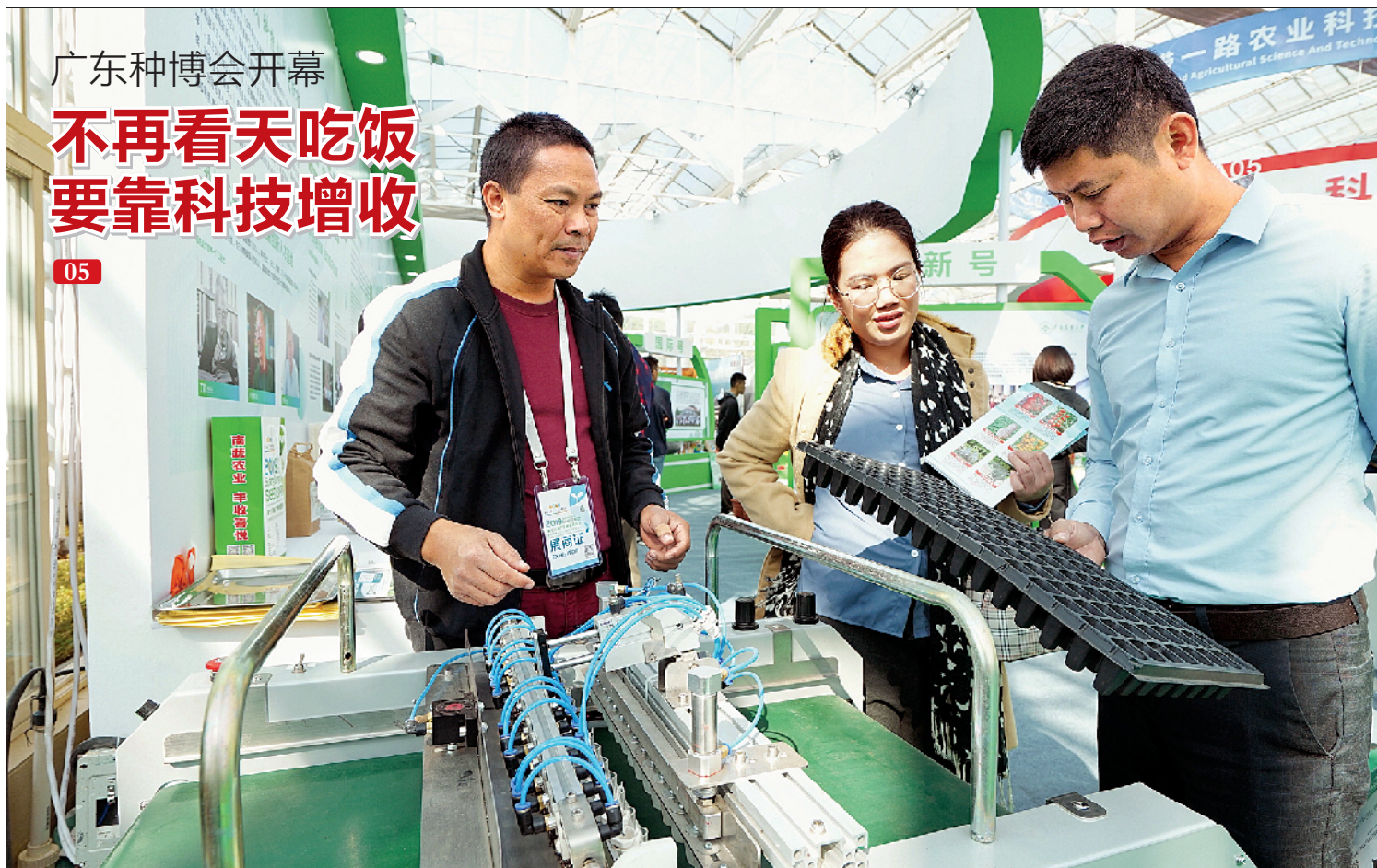
■在种博会华南农业大学展区,工作人员正在介绍一台小型蔬菜花卉精密播种机,该机器可以利用空气吸力完成播种,一台能完成10个人的工作量。 新快报记者 龚吉林/摄
