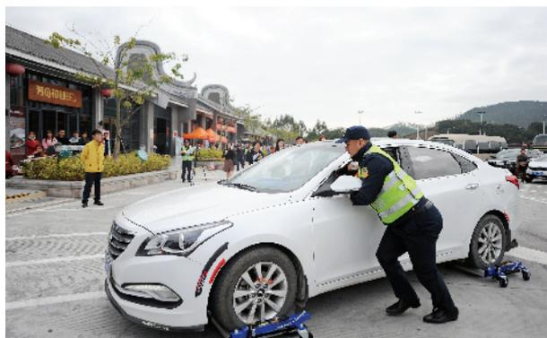
■“便携式移车器”利用四个带液压功能的辅助轮,将车辆的轮胎抬升,运用人力推动车辆至安全区域。 新快报记者 林里/摄
