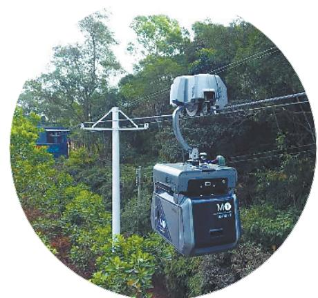
小时到货目标。线路建设成本约 50 万/km(双向两通道),加上各级基站建设成本,投资 5~10 亿(约 10 公里高速公路的成本)即可实现县域全覆盖。建成后,每运送 100 公斤货物行驶 100 公里,仅需 3~5 元电费,有潜力成为符合“集约高效、经济适用、智能绿色、安全可靠”要求的新型现代化基础设施。
