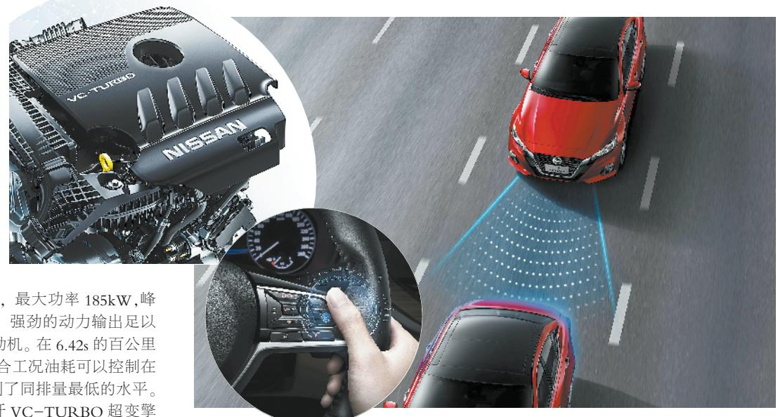
的智能无级切换,最大功率185kW,峰值扭矩380N·m,强劲的动力输出足以媲美一台V6发动机。在6.42s的百公里加速成绩下,综合工况油耗可以控制在6.6L/100km,做到了同排量最低的水平。究其缘由,离不开VC-TURBO超变擎发动机与全新智能XTRONIC CVT无级变速器的配合,真正做到了强动力与低油耗的完美兼容。
