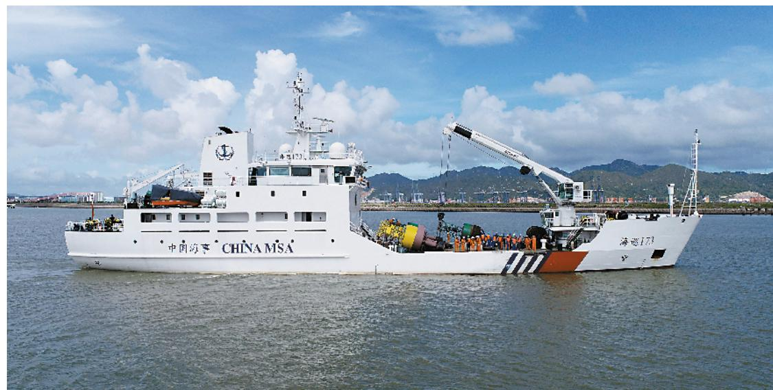
搭载北斗定位装置的大型航标船列编南海航保中心
