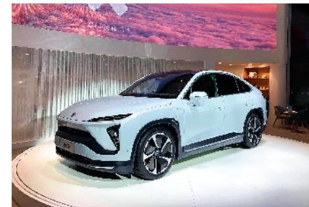
名版和性能版搭载前160kW高效能永磁电机+后240kW高性能感应电机组成的双电机智能四驱系统峰值功率544马力,最大扭矩725N·m,0—100km/h加速时间最快达到4.5秒。
