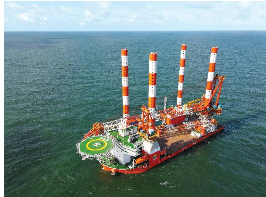
“华祥龙”船上甲板作业面积约2800平方米,艉部左舷设置绕桩式起重机2台,起重作业能力1200吨/350吨,全船可变载荷不低于5000吨。本船具备起重、运输、储存及补给等抢险打捞功能,是当之无愧的海上工作的多面手。全船定员达220人,艏部设生活楼和直升机起降平
