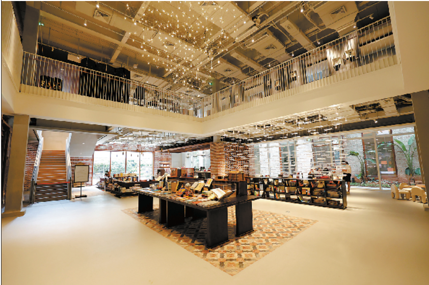
■侨商楼活化拆掉了柱、梁、楼板,打通内部空间,改变结构。
