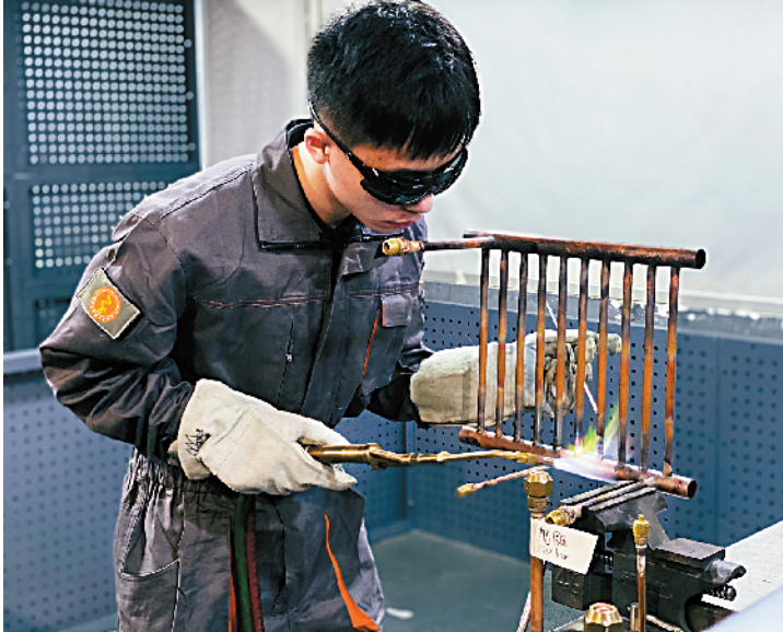
■制冷与空调项目参赛选手、广州工贸学生阮康正戴着专业墨镜,对制冷设备的铜管进行加工焊接。新快报记者 李小萌/摄
