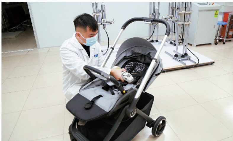
■广州海关技术中心对儿童推车进行围栏开口测试。通讯员供图
