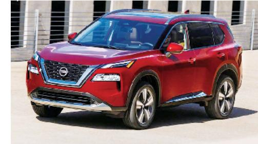
基于CMF平台打造的全新换代奇骏,外观内饰变化较大,科技感和精致程度有明显提升;相比现款车型,车身刚度提升27%,重量降低20kg;动力上,新车将继续搭载2.5L自然吸气发动机,传动系统匹配CVT变速箱,并提供四驱版。据悉,国产车型后期还有望换搭1.5T涡轮增压发动机。
