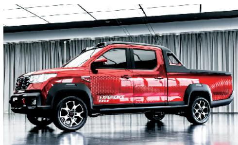
人民需要什么,五菱就造什么。继宏光MINI EV之后,五菱首款皮卡五菱征途再次引发热议。造型采用“机械美学”设计理念的这款新车,长宽高为5105×1640×1810mm,3160mm的轴距保证了优越的货箱尺寸,实现了巧身姿、大容量。货箱搭载了模块化的龙门架结构,兼顾装载力和观赏性。从目前公布的官图上看,新车色彩丰富,并在翼子板处的徽标式装饰件,龙门架上和铝车轮的卡钳上,均采用套色设计,整体尽显青春气息。储物空间方面,座椅后面搭载了小冰箱,可用于存放生鲜;车顶和座椅上方各自拥有置物空间,可以存放户外用品和钓鱼用具。
