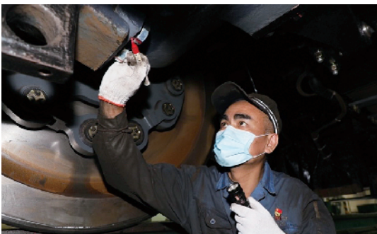
■刘沛希在机车底部给螺栓画防缓标识线。
