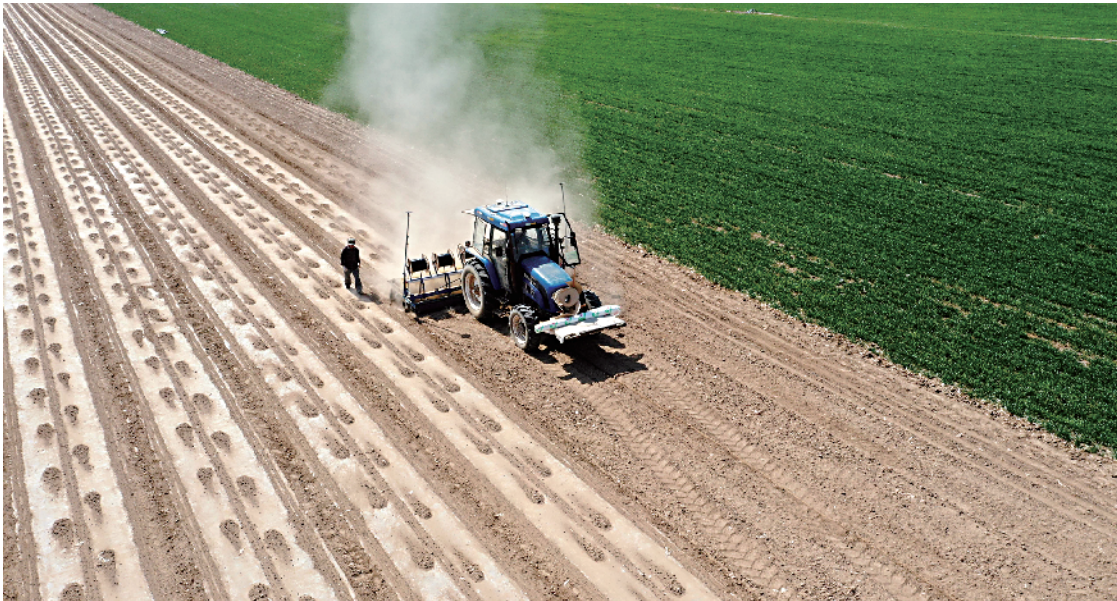
■在新疆生产建设兵团第六师共青团农场,一台安装北斗导航自动驾驶系统的播种机在播种棉花。 新华社资料照片
