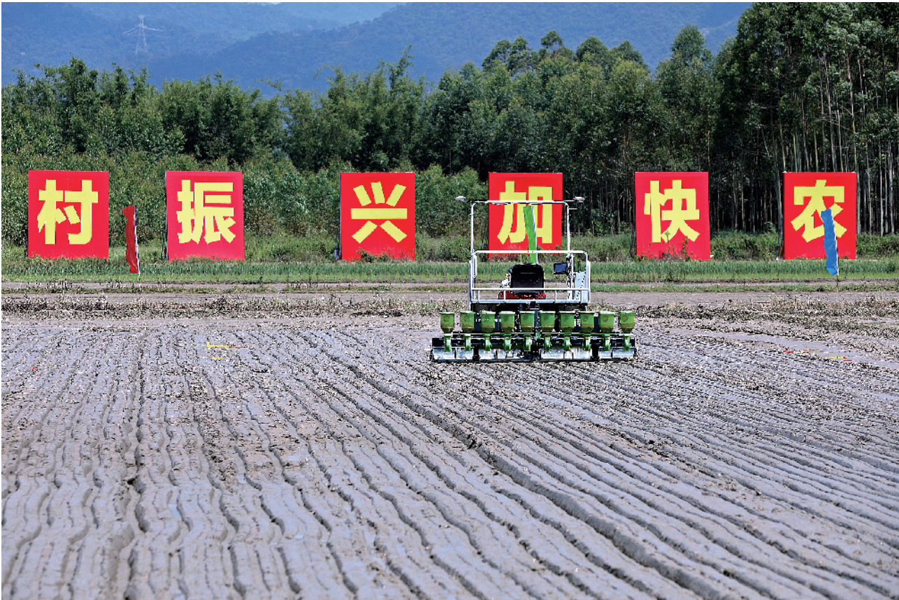
■无人驾驶水稻直播机实现了无人驾驶、自动作业、精准卸播、提高效率。
