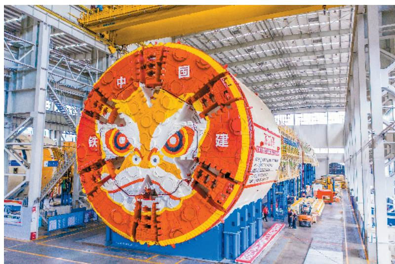
新快报讯 记者许力夫 通讯员刘福昌 宋明骏报道 日前,一台刀盘涂装着雄狮图案的大直径盾构机在长沙下线。这台取名为“深江1号”的盾构机开挖直径达13.42米,总长130米,总重3800吨,将参与国内最深海底隧道——深圳至江门铁路珠江口隧道工程建设。
