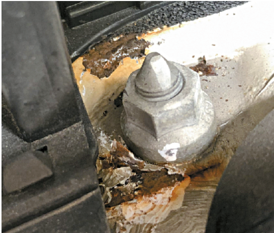
■车辆出现多处锈迹,严重处已分层脱落。受访者供图
