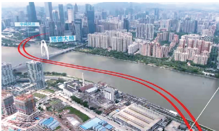
■十八号线磨碟沙至冼村区间,盾构机在掘进过程中两次转弯下穿珠江水系,在广州尚属首次。
