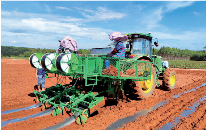
■香芋一体化种植机器正在实施播种作业。通讯员供图
