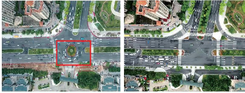
■改造前(左),部分时段车辆在环岛内“打结”;改造后(右),高峰时段车辆能一次通过。
