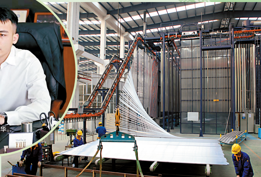
■华昌集团先后获评“首批国家绿色工厂”“广东省清洁生产企业”等荣誉称号,图为其智能立式铝合金型材粉末喷涂生产线。
