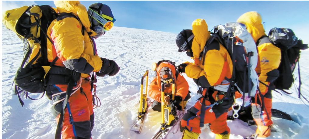
■科考队员用雷达测厚仪,在海拔8201米的卓奥友峰峰顶测量冰雪厚度。 新华社发
