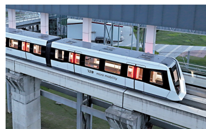
■一列三编组内嵌式中低速磁浮列车停在位于四川成都的磁浮示范线上。
