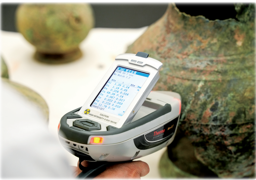
■便携式荧光检测仪,在短短一分多钟内即可显示文物的成分含量。
