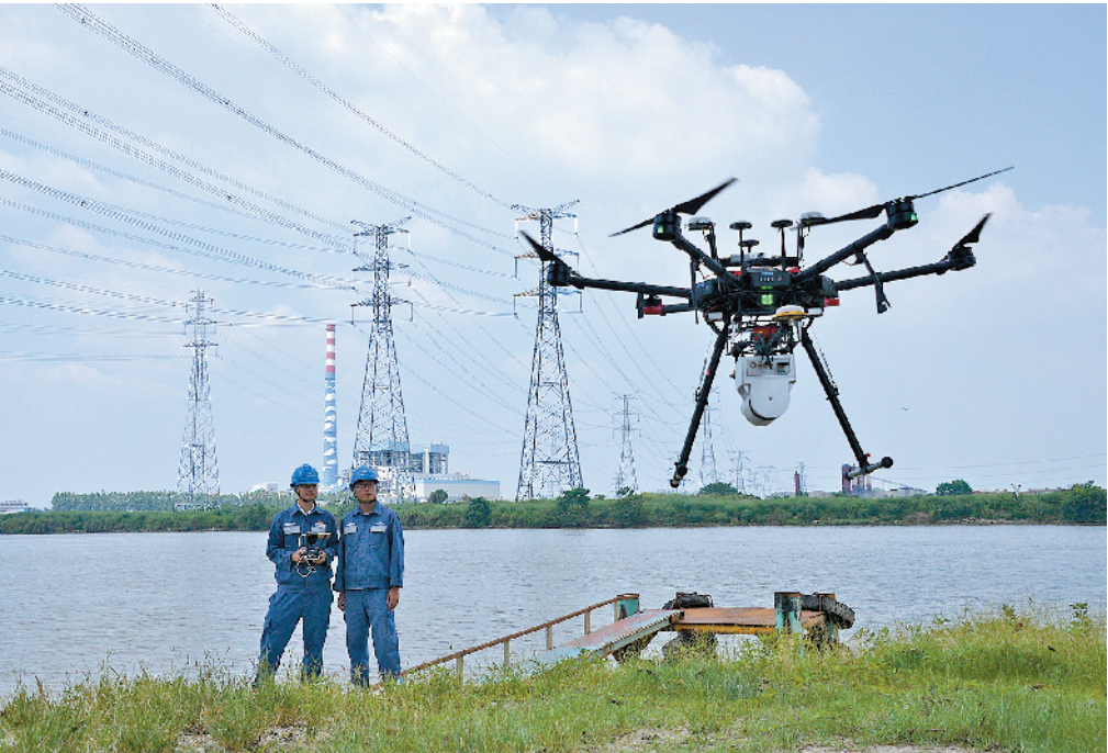
佛山供电局无人机团队——“佛电空军”对线行通道和杆塔设备等进行数据采集和厘米级建模
