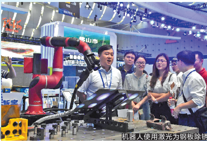
机器人使用激光为钢板除锈
