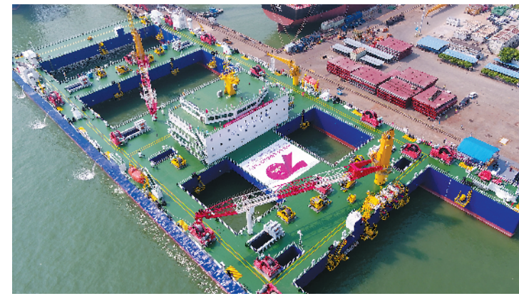
深中通道世界首制沉管隧道浮运安装一体船
