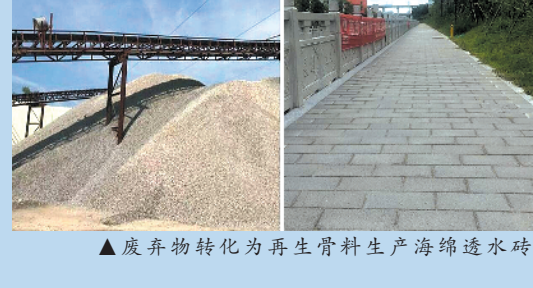
▲废弃物转化为再生骨料生产海绵透水砖
