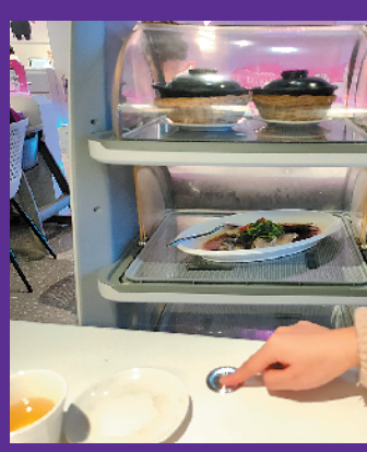
机器人精准送达座位，送餐机器人会自动停下，此时，顾客只需按一下桌面按钮，即可取出所点的菜。
