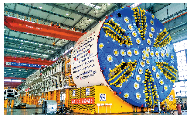
汕头海湾隧道西线隧道掘进使用的国产“巨无霸”盾构机
