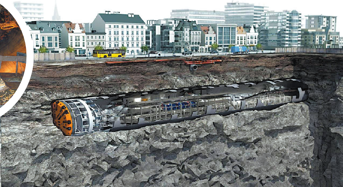
盾构机挖掘地铁隧道示意图
