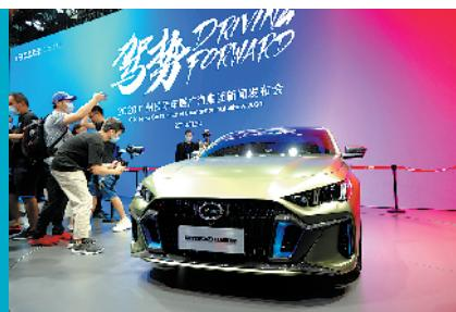
通过低车姿、短前悬、宽轮距、长轴距、宽车体的设计,EMPOW55实现了跑车般的低冲姿态,加以远低于同级的0.26超低风阻,达到了造型与性能的完美统一。
