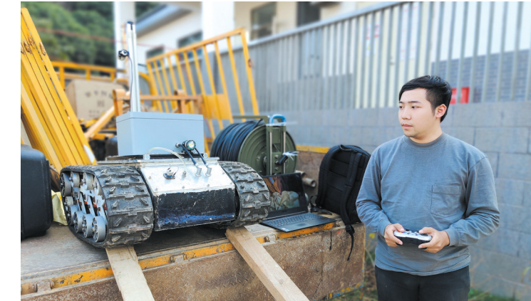
陈衍带领团队研发地下管网无人检测机器人 受访者供图
