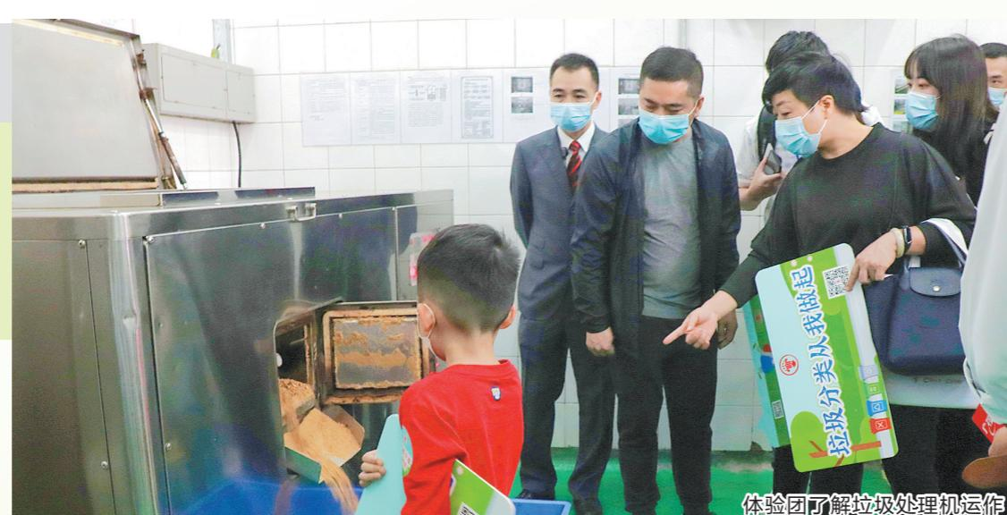
杨先生把参团市民带到一台厨余垃圾处理机旁。据悉,该处理机2016年起在此设置,具备将1吨厨余垃圾制成300公斤有机肥的能力,让部分厨余垃圾实现就地减量。
