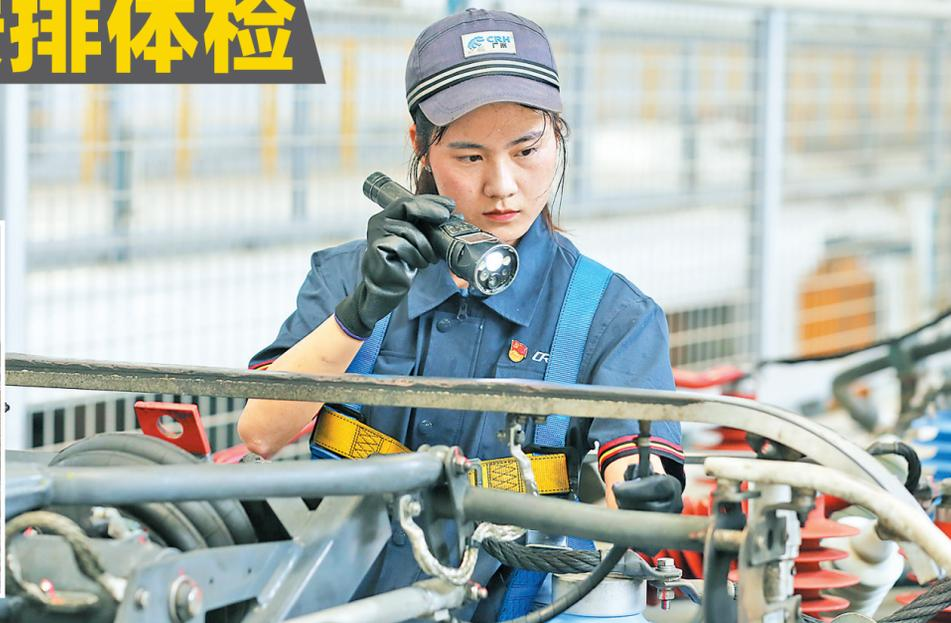
地勤机械师检查动车组车顶受电弓 石斌崇 摄
