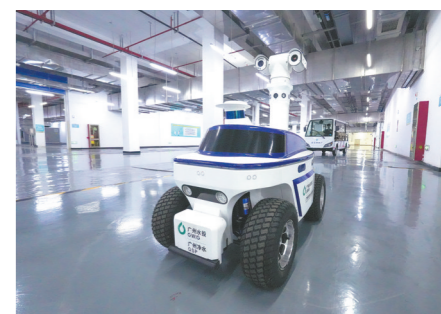
智能巡检机器人在广州水投净水公司沥滘净水厂进行自动巡检
