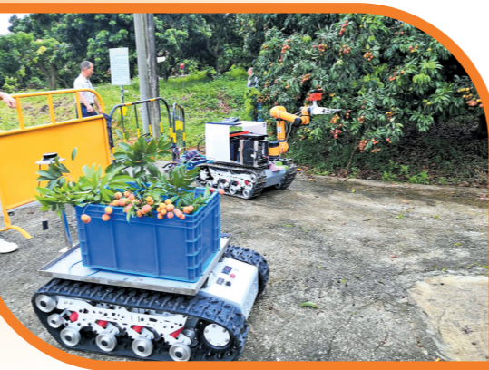
运用5G网络控制的荔枝采摘机器人及果园中转运输车 穆农宣 摄
