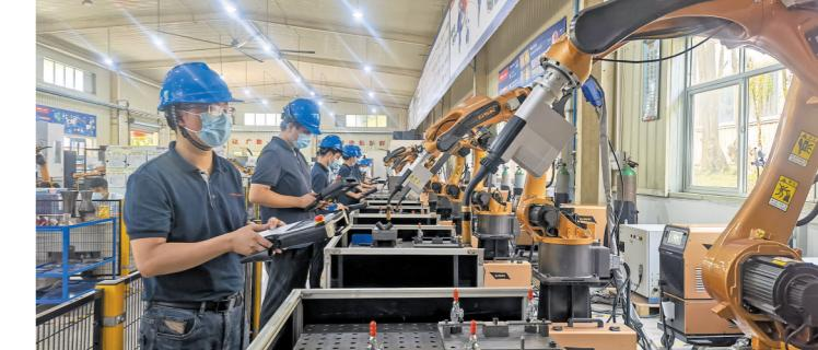
工业机器人系统运维员调试机器人
