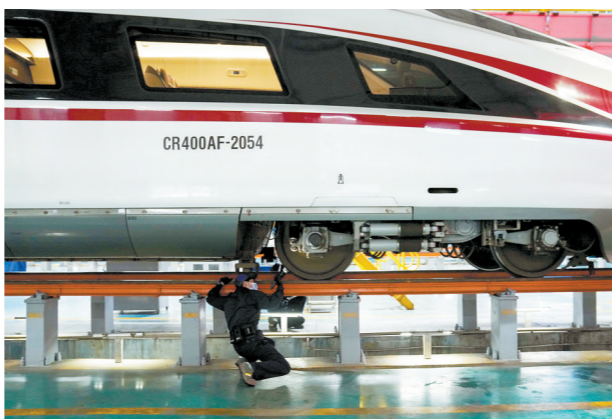
动车组机械师正在检查列车底部的装备和零件
