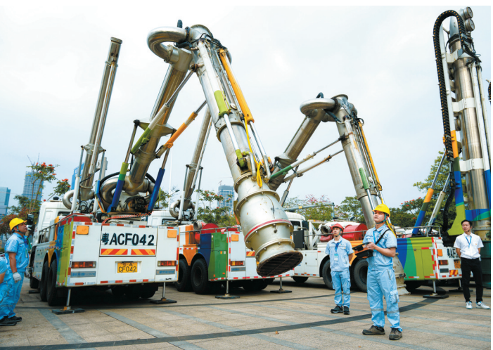
广州水投排水公司垂直式“龙吸水”在会场演示 通讯员供图
