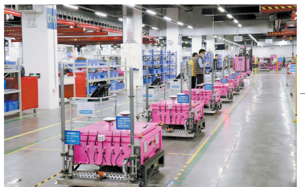
一批地面抹平机器人即将下线 (博智林公司供图)
