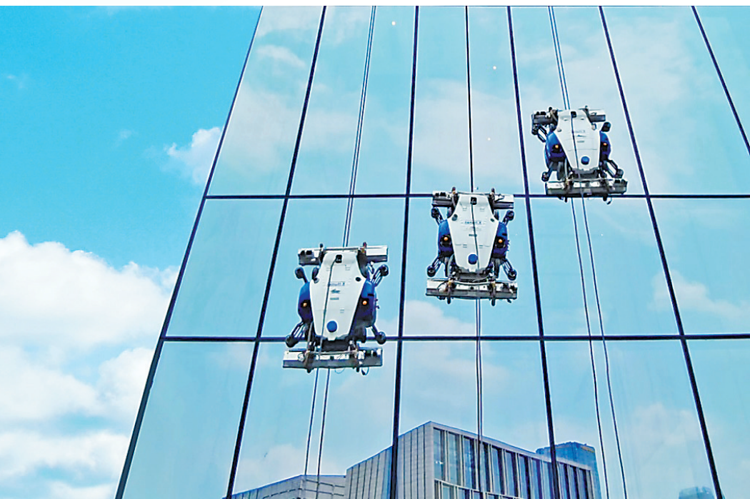
凌度机器人清洗玻璃幕墙 图/受访者提供
